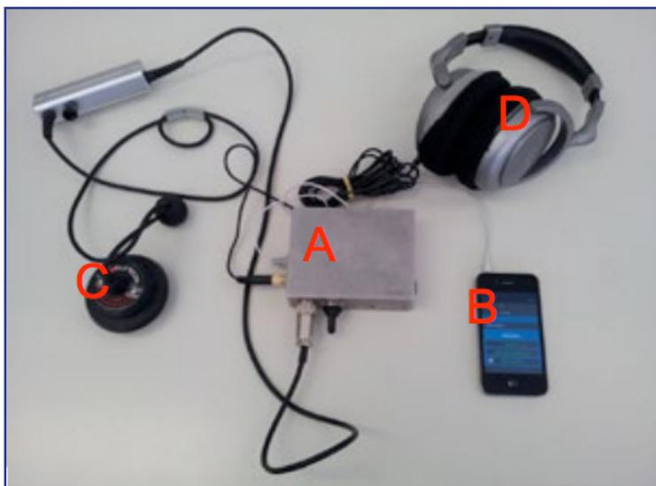
Sistema de condicionamento de sinal (A), unidade computacional portátil (B), sensor do tipo geofone (C) e fone de ouvido (D)
